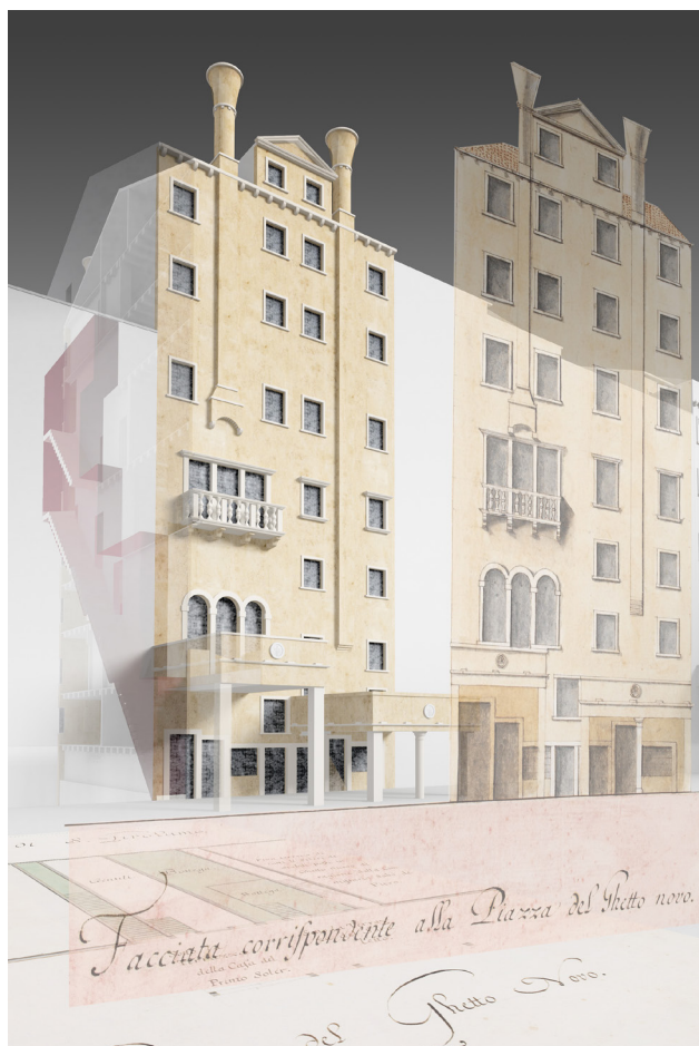
Figura 1 Ricostruzione da fonti iconografiche differenti di un modello BIM di un'abitazione del Ghetto Nuovo di Venezia. Autore P. Borin.
